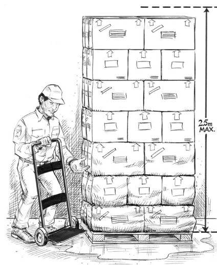
Figure 11. Exemple de boîtes écrasées en raison d'un empilage élevé
