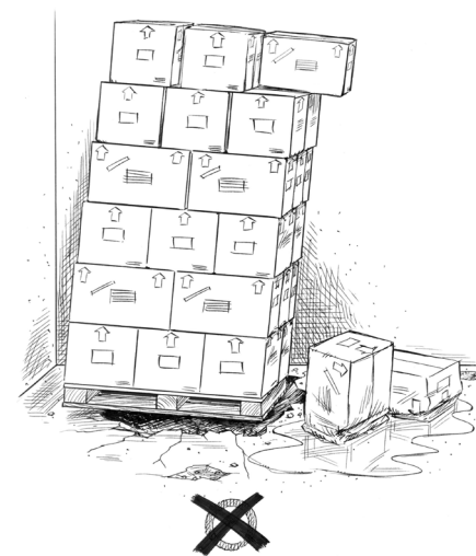
Figure 9. Palette qui bascule en raison d'un sol irrégulier
